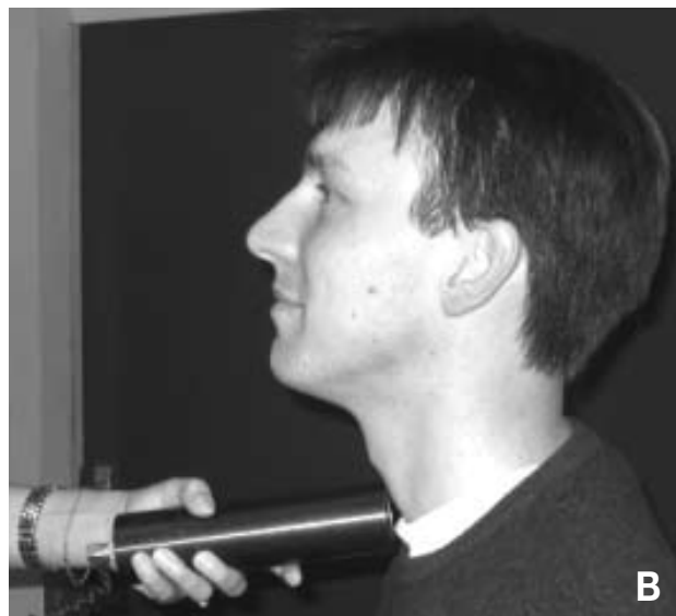
Figure 1b – Lorsqu'on suspecte une contamination radioactive (accidentelle), une mesure rapide au moyen d'un détecteur placé au contact de la thyroïde (pour augmenter la sensibilité de la mesure) permet de diagnostiquer ou d'éliminer l'existence d'une contamination. Ces appareils sont calibrés en Bq. Ce type de mesure effectué sur un millier de personnes à l'IRE n'a pas montré de contamination.
